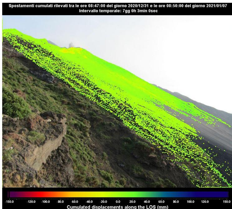
Figura 3 - Mappa degli spostamenti cumulati registrati dal sistema GB-InSAR NE190 riferito al tempo di 7 giorni e 3 minuti, dalle ore 08:47 UTC (09:47 ore locali) del 31 dicembre 2020 alle ore 08:50 UTC (09:50 ore locali) del 7 gennaio 2021.
