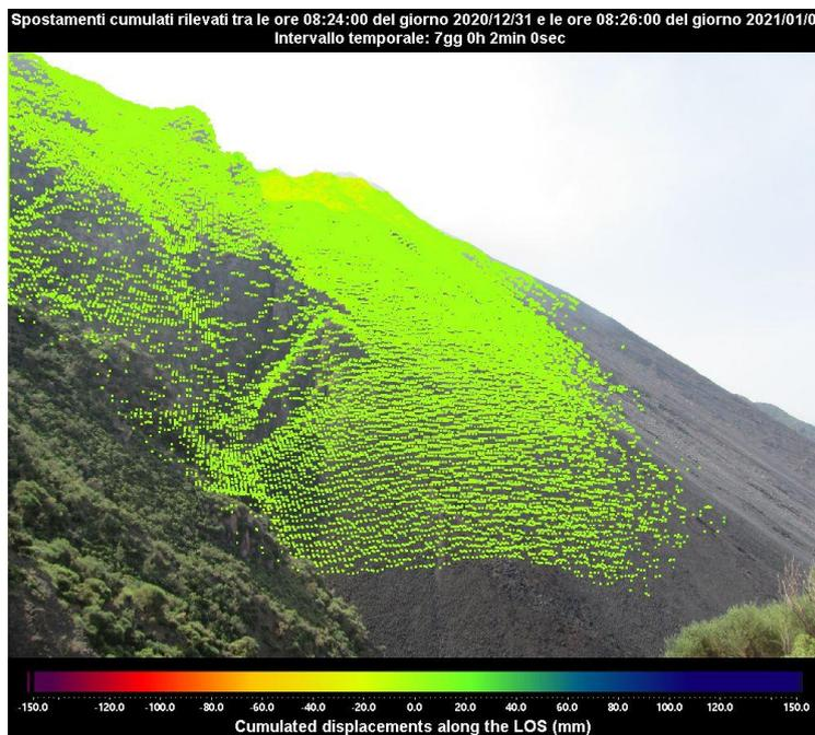
Figura 2 - Mappa degli spostamenti cumulati registrati dal sistema GB-InSAR NE400 riferito al tempo di 7 giorni e 2 minuti, dalle ore 08:24 UTC (09:24 ore locali) del 31 dicembre 2020 alle ore 08:26 UTC (09:26 ore locali) del 7 gennaio 2021.
