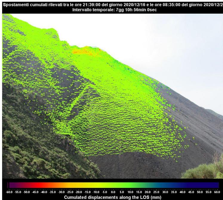
Figura 2 - Mappa degli spostamenti cumulati registrati dal sistema GB-InSAR NE400 riferito al tempo di 7 giorni e 10 ore, dalle ore 21:39 UTC (22:39 ore locali) del 16 dicembre 2020 alle ore 08:35 UTC (10:35 ore locali) del 24 dicembre 2020.
