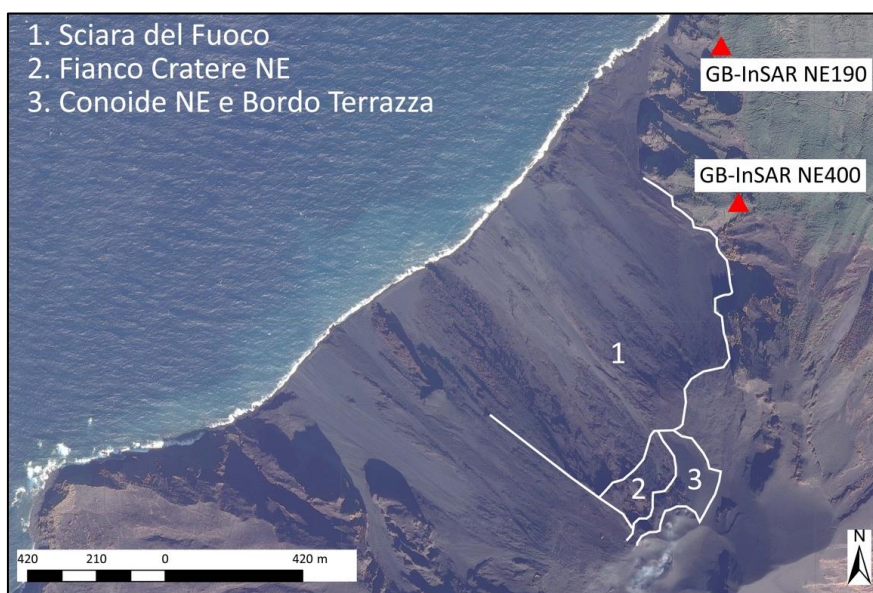
Figura 1 - Mappa dei settori monitorati mediante i sistemi radar GB-InSAR NE190 e GB-InSAR NE400.
