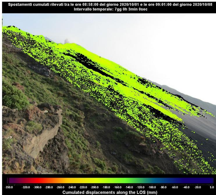
**Figura 1 - Mappa degli spostamenti cumulati registrati dal sistema GB-InSAR NE190 riferito al tempo di 7 giorni e 3 minuti, dalle ore 08:58 UTC (10:58 ore locali) del 01 ottobre 2020 alle ore 09:01 UTC (11:01 ore locali) del 08 ottobre 2020.**
