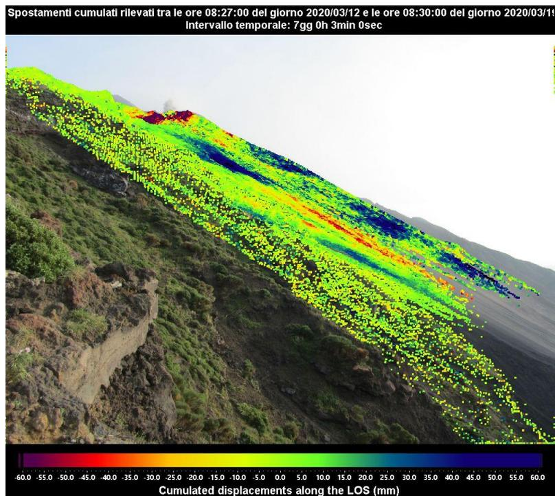
Figura 3 - Mappa degli spostamenti cumulati registrati dal sistema GB-InSAR NE190 riferito al tempo di 7 giorni e 3 minuti, dalle ore 08:27 UTC (09:27 ore locali) del 12 marzo 2020 alle ore 08:30 UTC (09:30 ore locali) del 19 marzo 2020.
