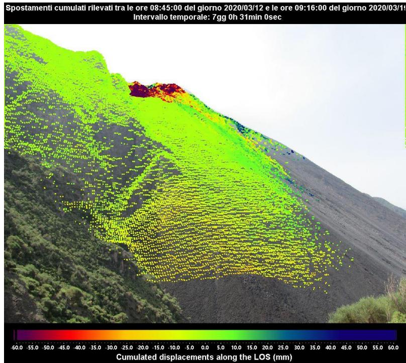
Figura 2 - Mappa degli spostamenti cumulati registrati dal sistema GB-InSAR NE400 riferito al tempo di 7 giorni e 31 minuti, dalle ore 08:45 UTC (09:45 ore locali) del 12 marzo 2020 alle ore 09:16 UTC (10:16 ore locali) del 19 marzo 2020.
