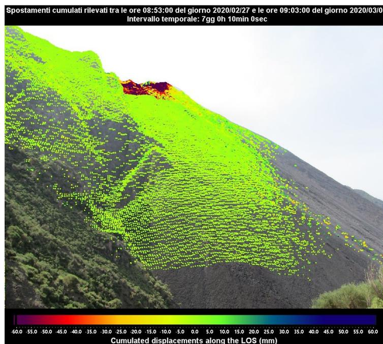
Figura 1 - Mappa degli spostamenti cumulati registrati dal sistema GB-InSAR NE400 riferito al tempo di 7 giorni e 10 minuti, dalle ore 08:53 UTC (09:53 ore locali) del 27 febbraio 2020 alle ore 09:03 UTC (10:03 ore locali) del 5 marzo 2020.
