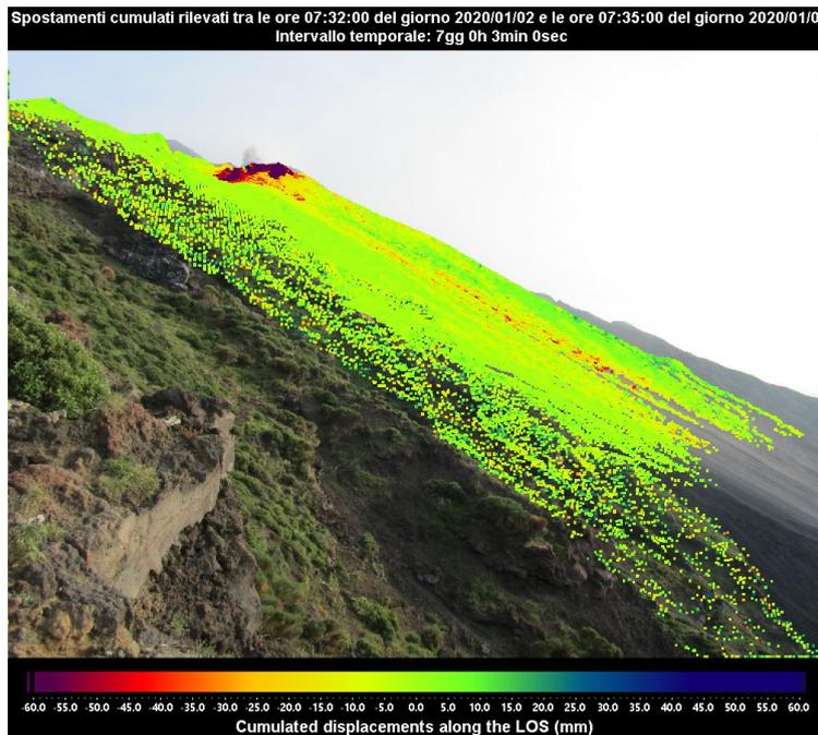
Figura 1 - Mappa degli spostamenti cumulati registrati dal sistema GB-InSAR NE190 riferito al tempo di 7 giorni e 3 minuti, dalle ore 07:32 UTC (08:32 ore locali) del 2 gennaio 2020 alle ore 07:35 UTC (08:35 ore locali) del 9 gennaio 2020.
