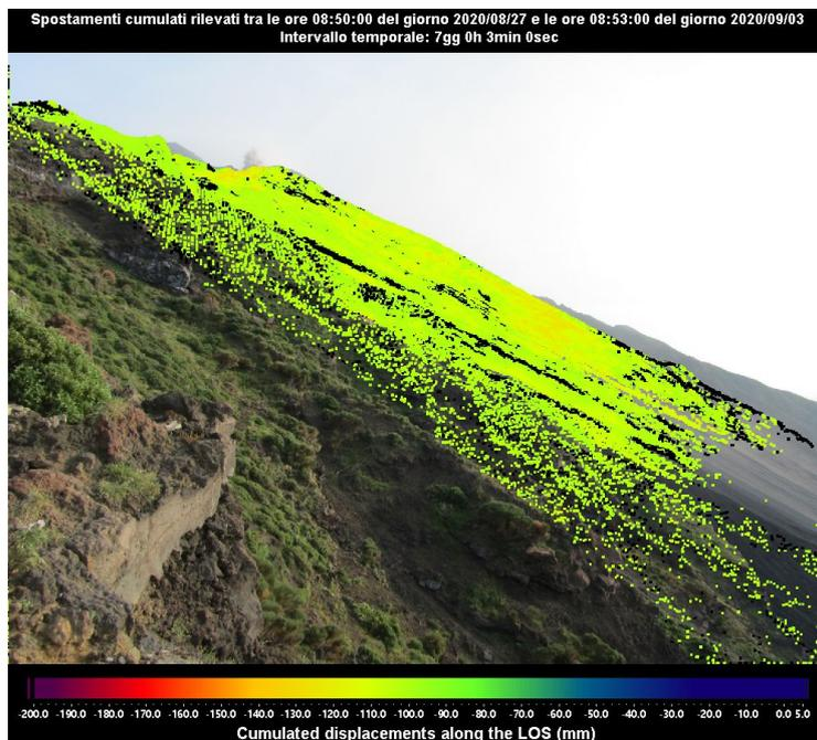
Figura 3 - Mappa degli spostamenti cumulati registrati dal sistema GB-InSAR NE190 riferito al tempo di 7 giorni e 3 minuti, dalle ore 08:50 UTC (10:50 ore locali) del 27 agosto 2020 alle ore 08:53 UTC (10:53 ore locali) del 3 settembre 2020.
