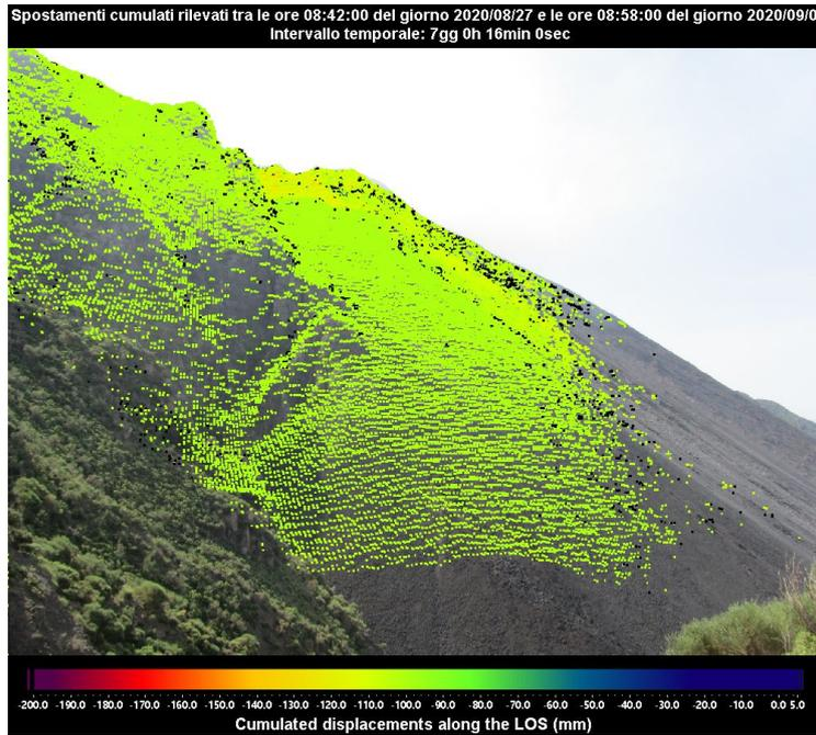
Figura 1 - Mappa degli spostamenti cumulati registrati dal sistema GB-InSAR NE400 riferito al tempo di 7 giorni e 16 minuti, dalle ore 08:42 UTC (10:42 ore locali) del 27 agosto 2020 alle ore 08:58 UTC (10:58 ore locali) del 3 settembre 2020.
