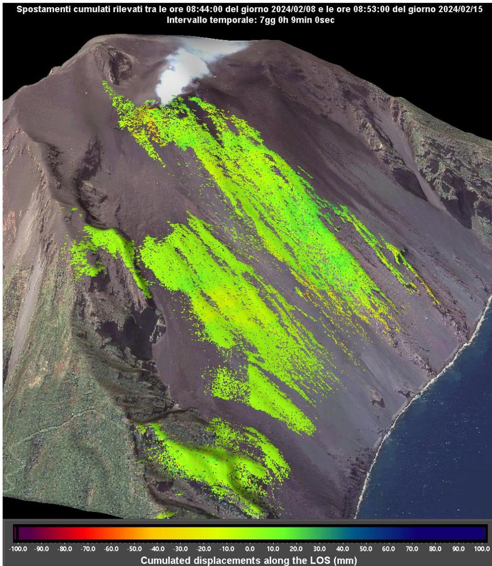
**Figura 2 –** Mappa degli spostamenti cumulati registrati dal sistema GBInSAR NE190 riferito al tempo di 7 giorni e 9 minuti dalle ore 08:44 UTC (09:27 ora locale) del 09 febbraio 2024 alle ore 08:53 UTC (09:53 ore locali) del 15 febbraio 2024.
