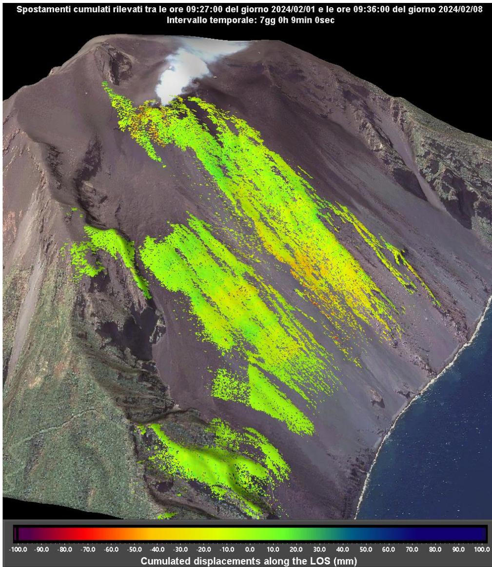
**Figura 2 –** Mappa degli spostamenti cumulati registrati dal sistema GBInSAR NE190 riferito al tempo di 7 giorni e 9 minuti dalle ore 09:27 UTC (10:27 ora locale) dell'01 febbraio 2024 alle ore 09:36 UTC (10:36 ore locali) del 08 febbraio 2024.
