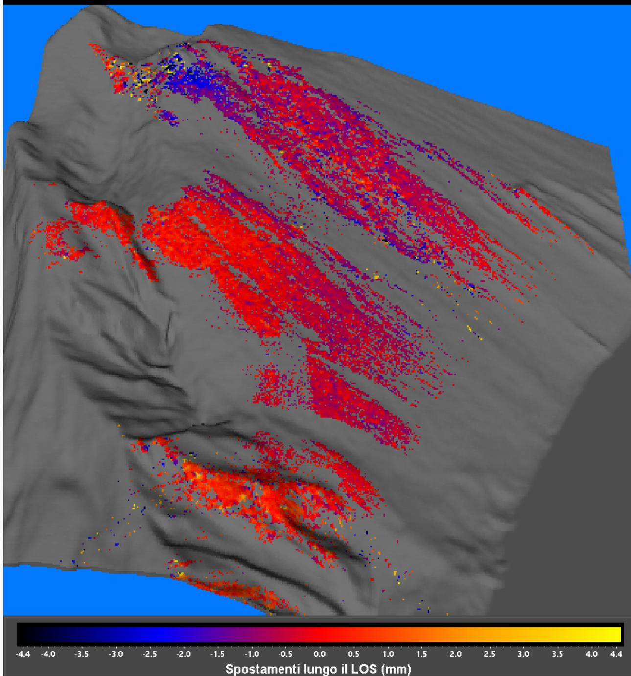
**Figura 2 – Spostamento cumulato registrato dal sistema GBInSAR NE190 riferito al tempo di 3 giorni e 9 minuti dalle ore 07:01 UTC (09:01 ora locale) del 10 aprile 2023 alle ore 07:10 UTC (09:10 ore locali) del 13 aprile 2023.**
