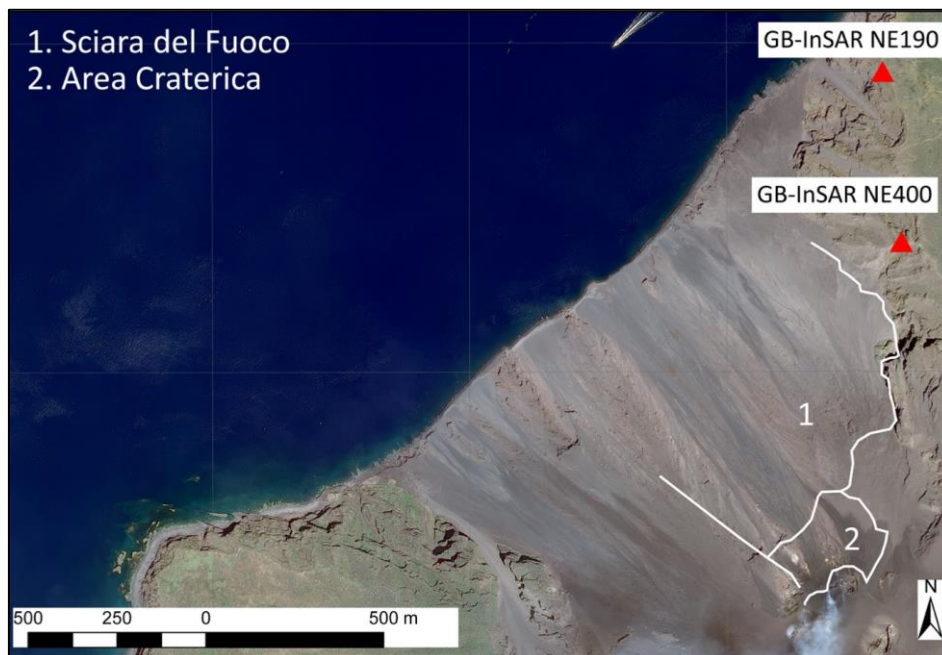
Figura 1 - Mappa dei settori monitorati mediante i sistemi radar GBInSAR NE190 e GBInSAR NE400.
