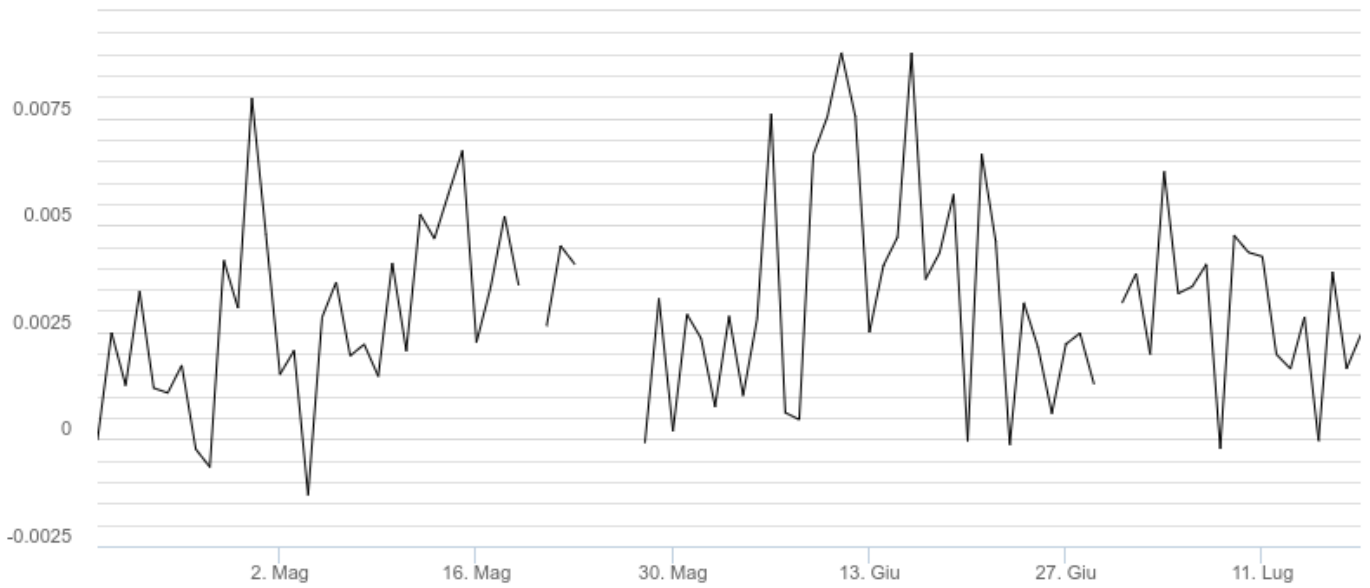
Fig. 11.1 Serie temporale della variazione di distanza, in metri, tra le stazioni Vulcano Cratere (IVCR) e Grotta Palizzi (IVGP) durante gli ultimi tre mesi.
