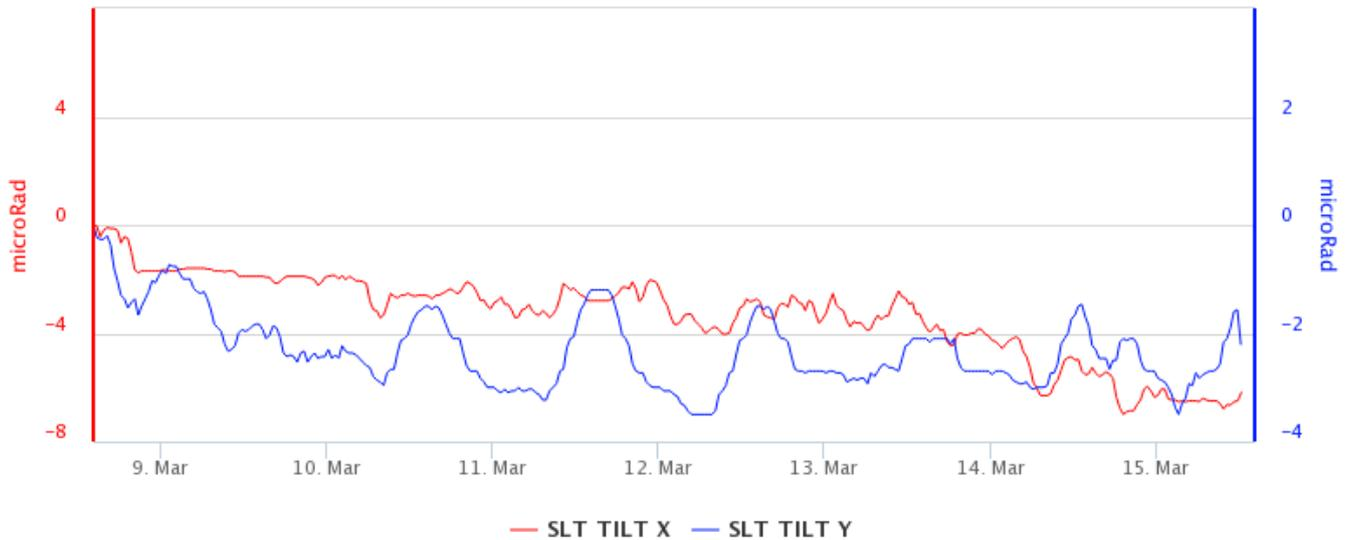
Fig. 12.1 Serie temporale delle componenti Radiale (X) e Tangenziale (Y) del clinometro di SLT dell'ultima settimana.
