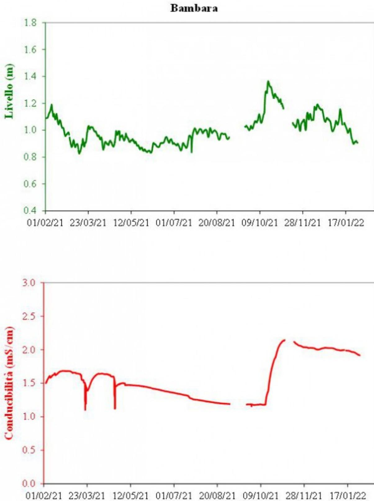
Fig. 8.2 Dati di livello freatico e di conducibilità riportata a 20°C, acquisiti in automatico nel pozzo Bambara.
