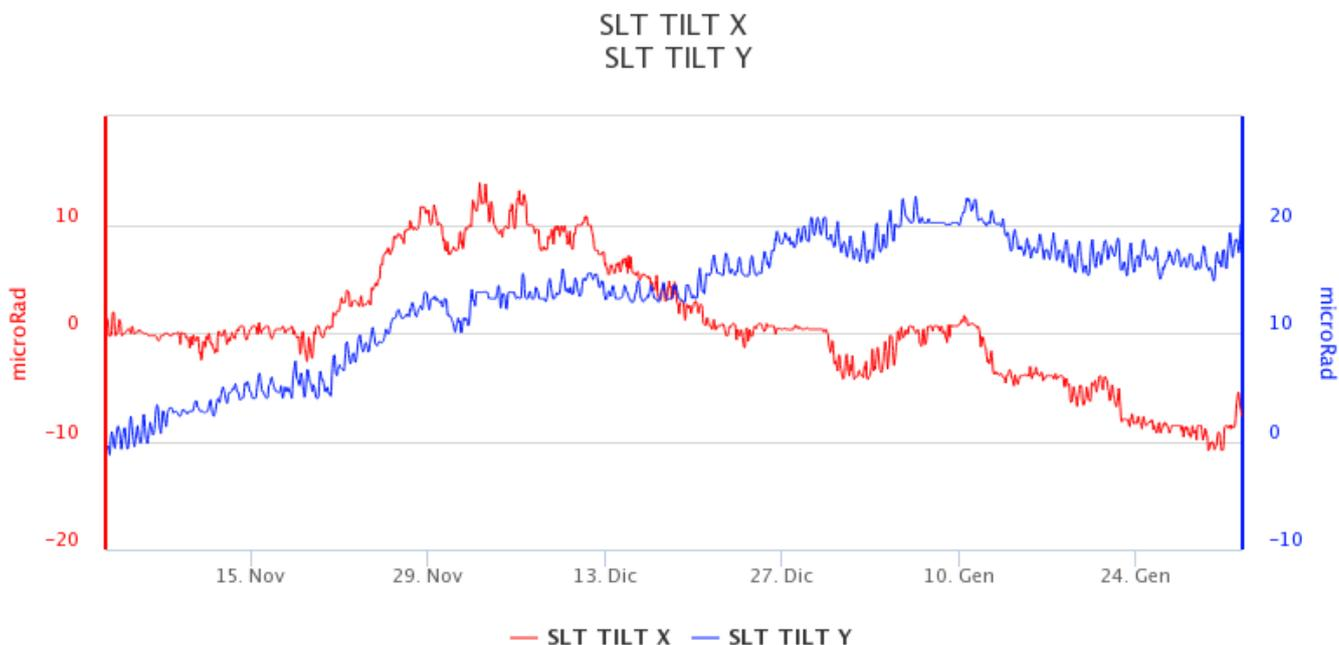
**Fig. 12.1** Serie temporali delle componenti radiale (X) e tangenziale (Y) del clinometro SLT durante gli ultimi tre mesi
