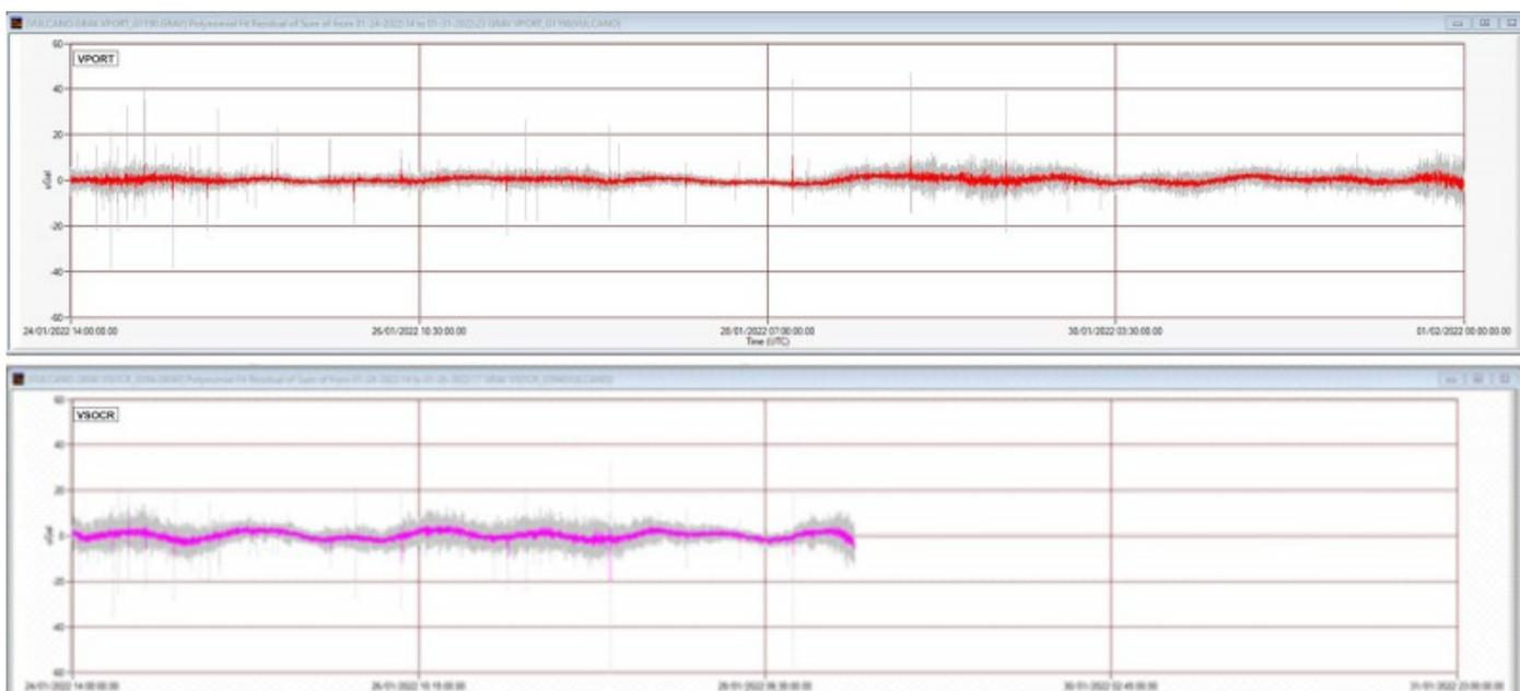
**Fig. 13.3** Segnale gravimetrico registrato nelle stazioni VPORT (in alto) e VSOCR (in basso) dalle 14:00 UTC del 24 alle 23:00 UTC del 31 gennaio 2022. In grigio i segnali acquisiti al secondo; le tracce colorate indicano i segnali mediati al
