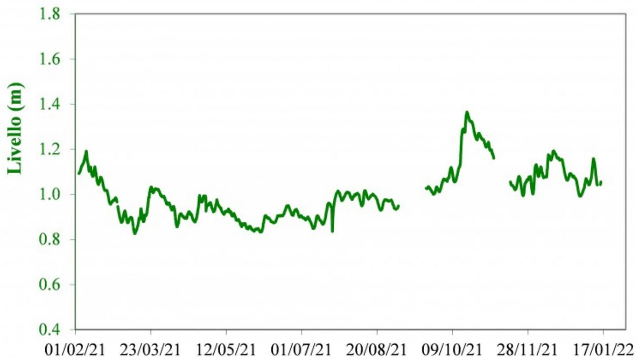
Fig. 8.2 Dati di livello freatico acquisiti in automatico nel pozzo Bambara.
