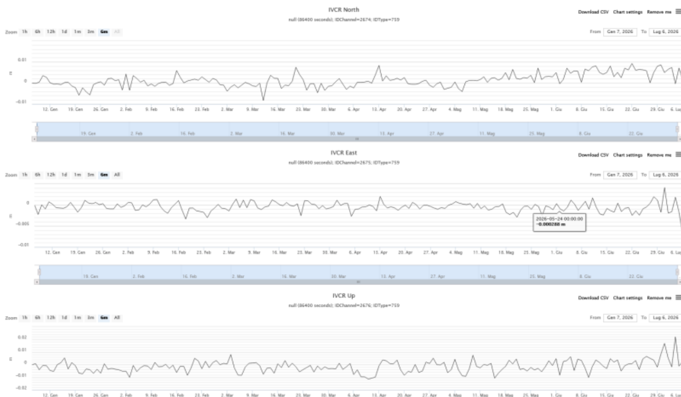
Fig. 11.1 Serie temporali delle variazioni delle componenti orizzontali (Nord e Est) e di quota della stazione IVCR
