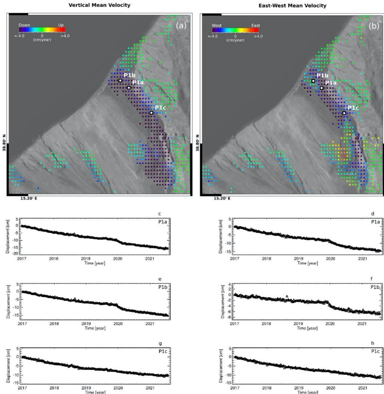
Figura 2. Mappe delle componenti Verticale ed Est-Ovest della velocità media di deformazione dell'area settentrionale della Sciara del Fuoco relative al periodo 24 aprile 2015 – 21 luglio 2021. a) Componente Verticale. b) Componente Est-Ovest. c-h) Andamento temporale della deformazione lungo la direzione Verticale (c)(e)(g) ed Est-Ovest (d)(f)(h) in corrispondenza di tre punti identificati come P1a, P1b e P1c in (a)-(b) nel periodo gennaio 2017 – luglio 2021.
