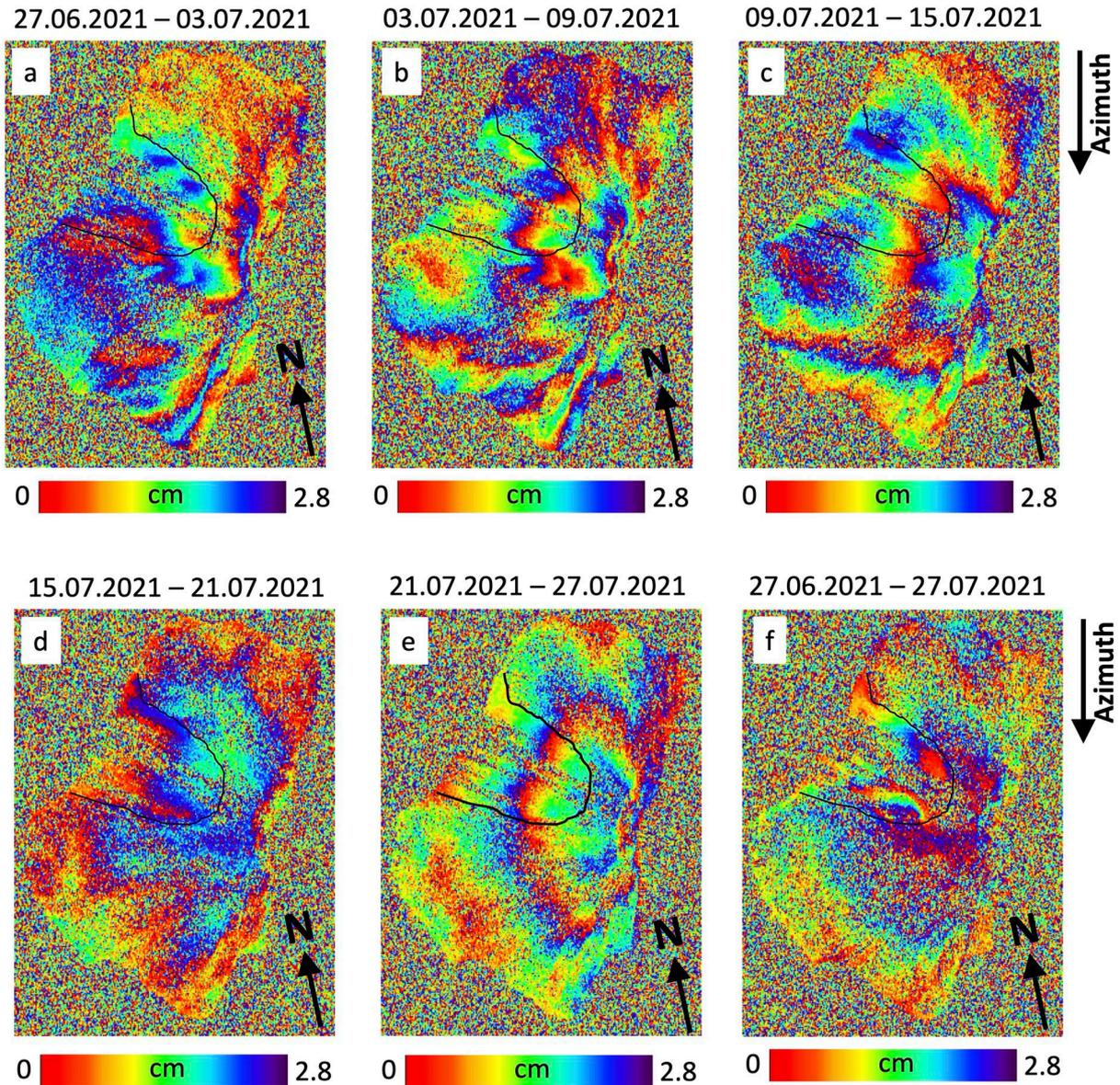
Figura 3. Interferogrammi differenziali, in geometria radar, generati a partire da dati acquisiti lungo orbite discendenti dai sensori Sentinel-1. a-e) Interferogrammi consecutivi a 6 giorni a partire dall'acquisizione del 27 giugno 2021 fino a quella del 27 luglio 2021. f) Interferogramma relativo all'ultimo mese analizzato. In nero sono indicati i confini della Sciara del Fuoco, per riferimento.
