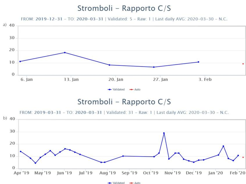
**Fig. 6.2** - Andamento medio settimanale del rapporto CO<sub>2</sub>/SO<sub>2</sub> nel plume: a) ultimi tre mesi; b) ultimo anno
