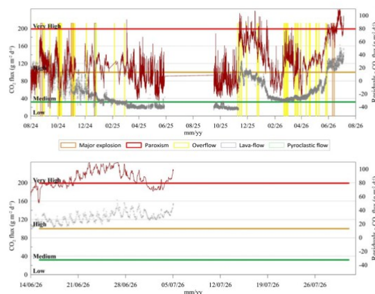
Fig. 6.5 Andamento del flusso medio giornaliero di CO 2 dal suolo registrato a Mofete corretto per i parametri ambientali negli ultimi due anni (grafico in alto) e dettaglio delle ultime 2 settimane (grafico in basso).
