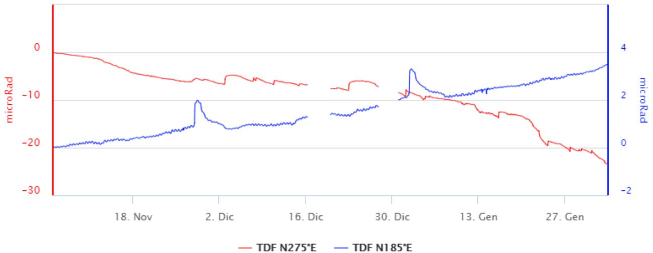
**Fig. 5.2** - Variazione dell'inclinazione del suolo alla stazione clinometrica di TDF [microradianti].
