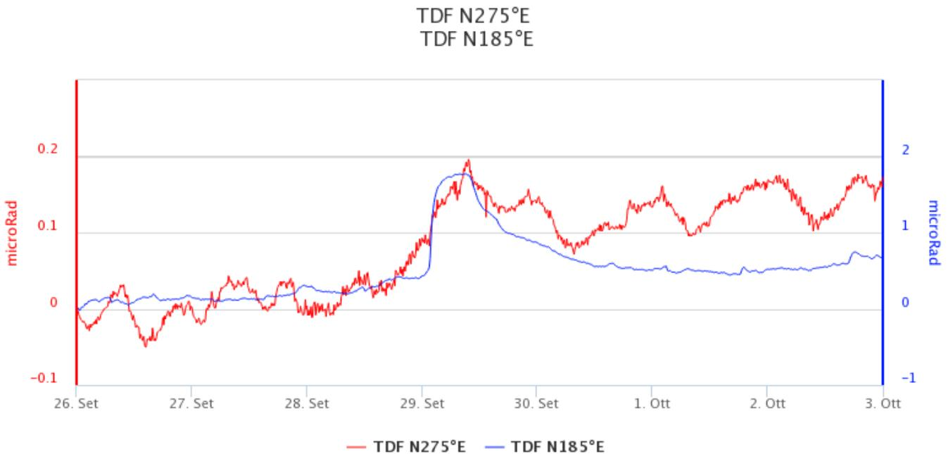
**Fig. 5.2** Serie temporali delle componenti X e Y del tilt TDF durante l'ultima settimana.
